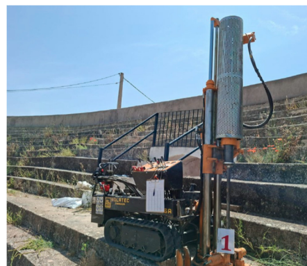
trabajos de campo: escaneo por nube de puntos / perforaciones en muro y ensayos de penetración dinámica
