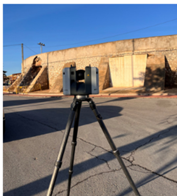
trabajos de campo: escaneo por nube de puntos / perforaciones en muro y ensayos de penetración dinámica
